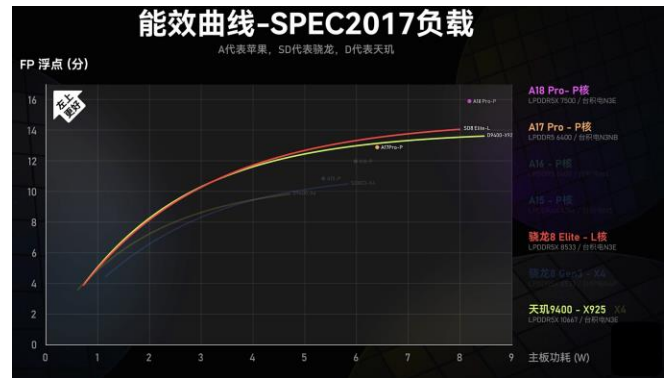
图表25: 手机旗舰 SoC CPU 能效曲线 (浮点)
