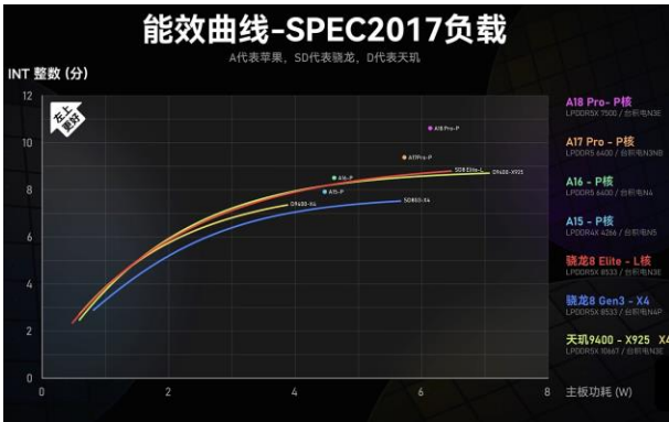
图表24: 手机旗舰 SoC CPU 能效曲线 (整数)
