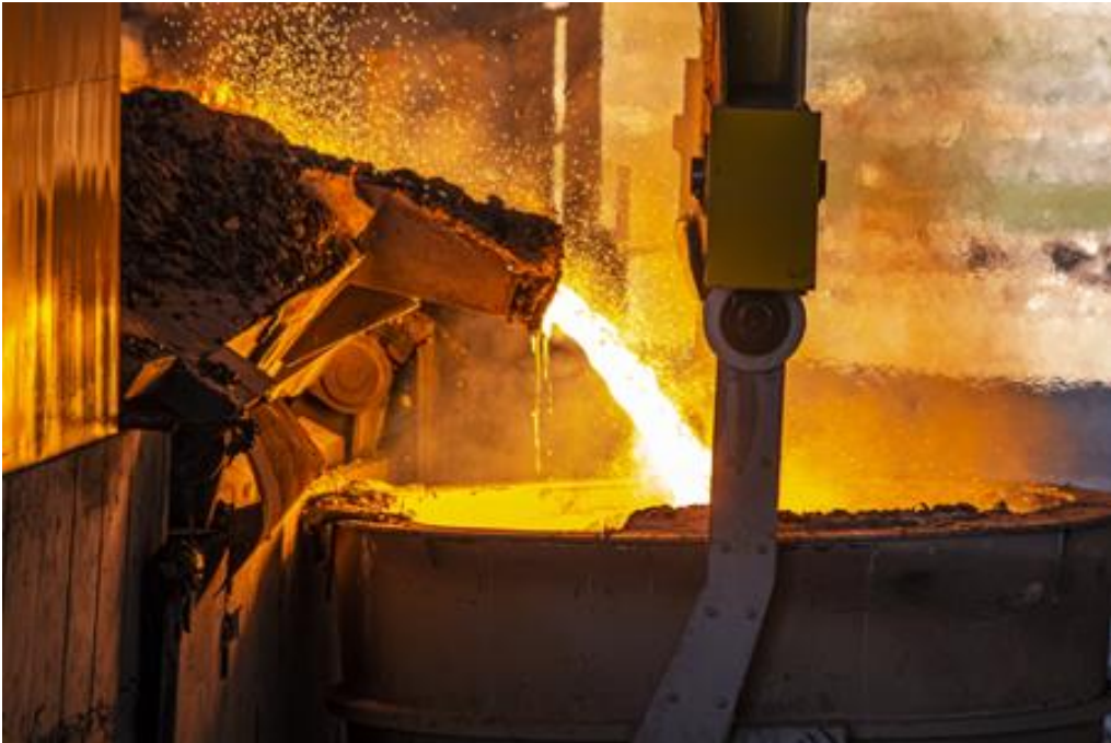
图22：浇铸前将熔化的金属转移到钢包中 27
