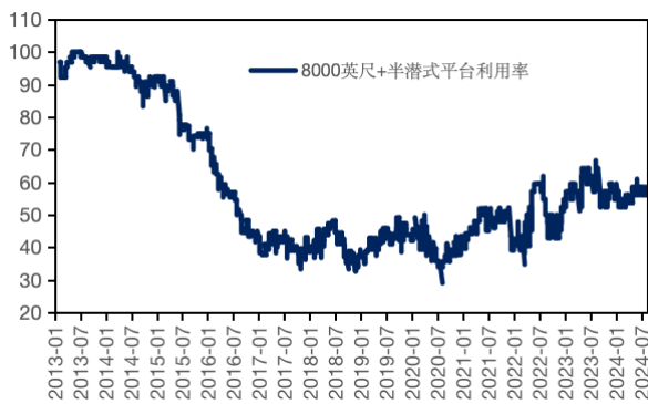
图 20：8000 英尺+半潜式钻井平台利用率 (%)
