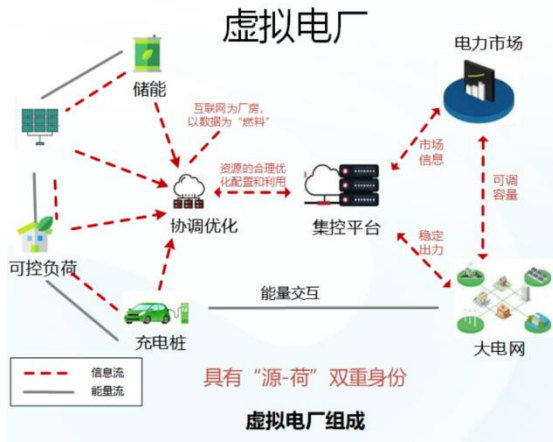
图38: 虚拟电厂实体组成
